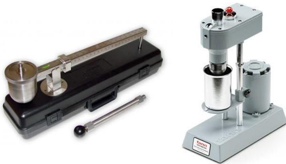
Figura 8. Equipos estandarizados de laboratorio para el monitoreo de propiedades reológicas y densidad (Balanza presurizada y Viscosímetro rotacional) (Fajardo Vélez & Rojas Quimbaya, 2016)
