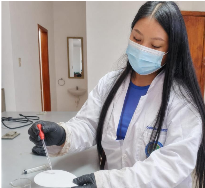
Anexo 10. Adición de gotas de mezcla en papel filtro para prueba de la mancha.
