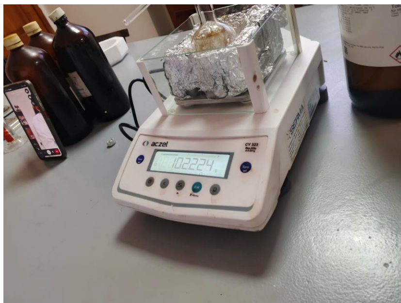
Anexo 3. Peso en balanza electrónica del balón de precipitación
