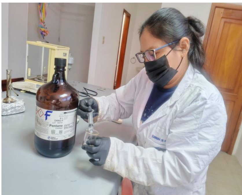
Anexo 7. Mezcla de la destilación con el aditivo para aplicar sobre papel filtro.
