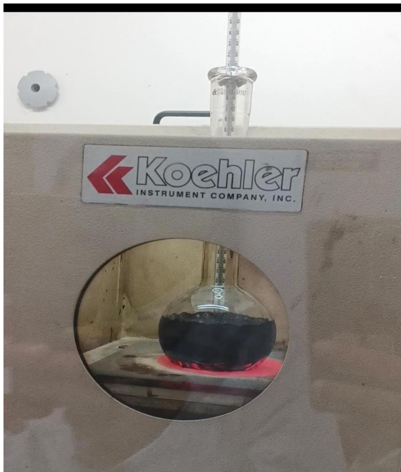
Anexo 11. Tratamiento térmico de muestra de crudo en la cámara de destilación.
