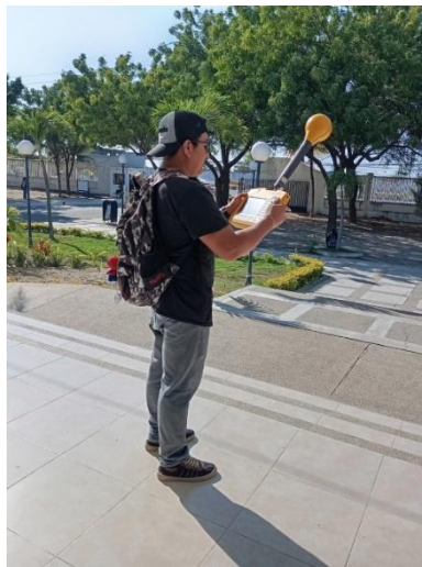
Figura 43. Medición de campo con el equipo Narda SRM-3006 y sonda isotrópica en el área de estudio.
