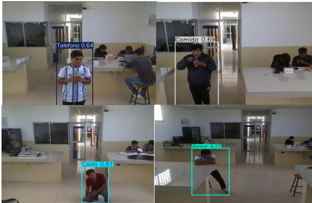
Figura 55. Detección de anomalías mediante regiones de interés (ROI).
