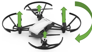
Figura 24. Rotación en sentido horario.
