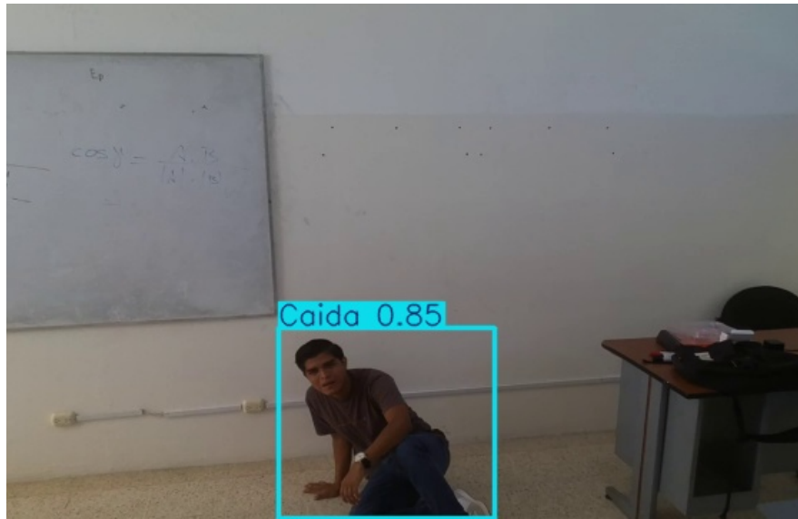
Figura 45. Detección de anomalías en tiempo real mediante YOLOv8.
