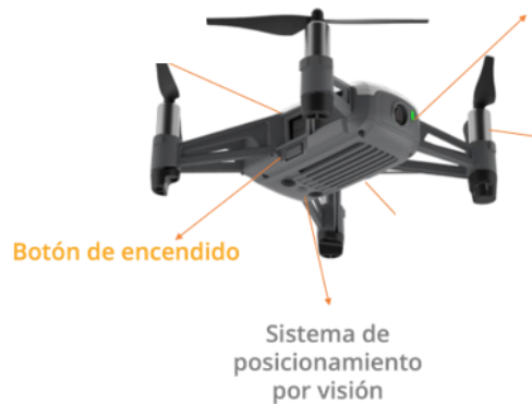
Figura 16. Sistema de posicionamiento visual en el dron DJI Tello
