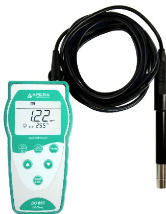
Figura 6. Kit medidor portátil de oxígeno disuelto DO850. Fuente: (CTR, s.f.).
