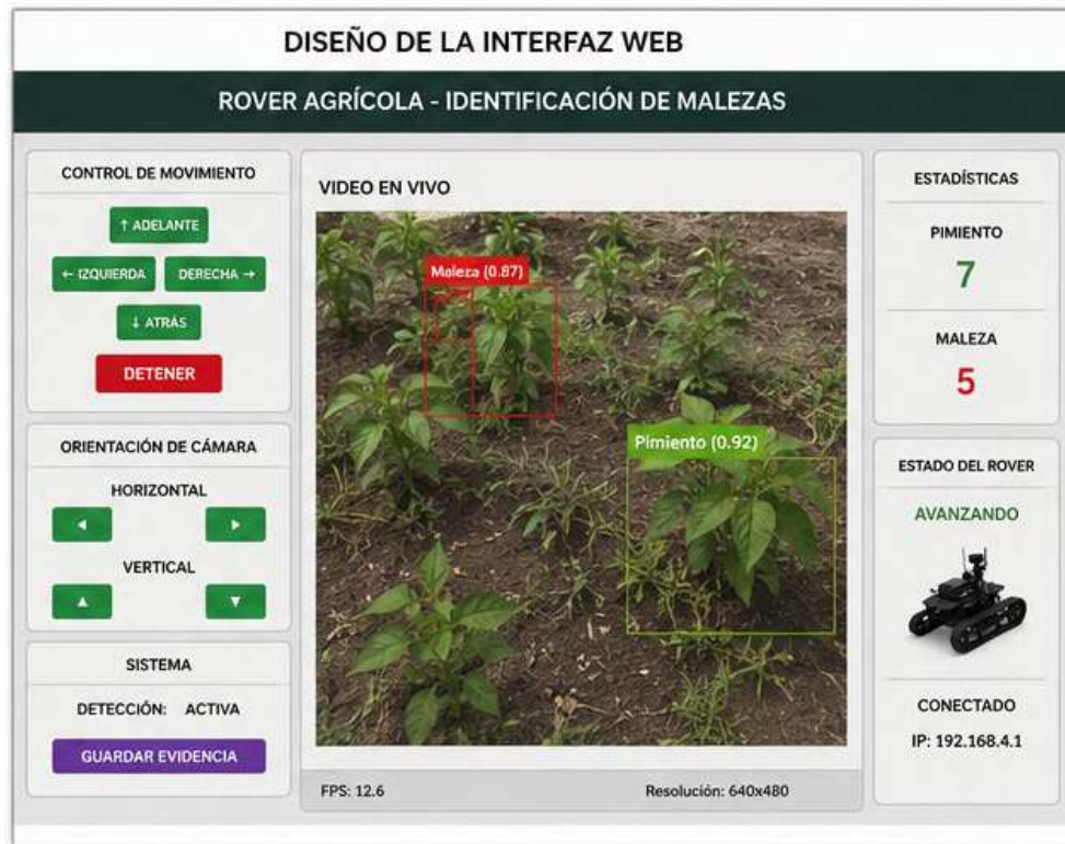
Figura 21: Interfaz web diseñada para el control y supervisión del rover. Fuente: Autor.
