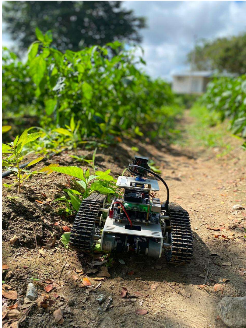
Figura 23: Rover Transbot-SE ensamblado para la adquisición y procesamiento de imágenes agrícolas. Fuente: Autor.
