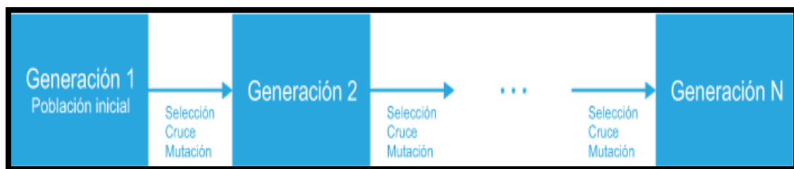
Figura 13 - Esquema de funcionamiento de un algoritmo genético (Gutiérrez et al., n.d.).
