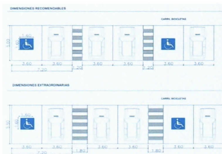
Gráfico 17: Medidas del Estacionamiento Accesible
