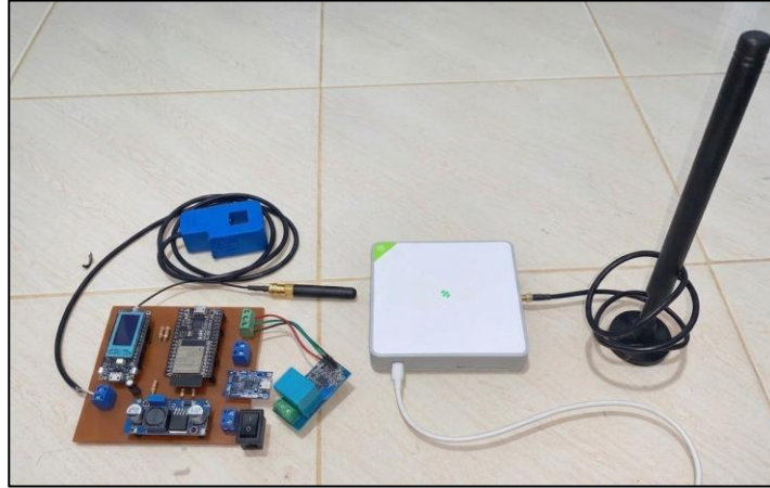
Figura 89. Prototipo implementado, gateway SenseCAP M2 y antena
